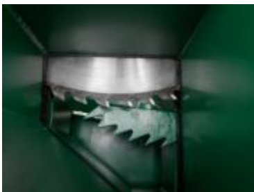
Hartmetall-Sägeblatt D 700 mm & Niederhalter
